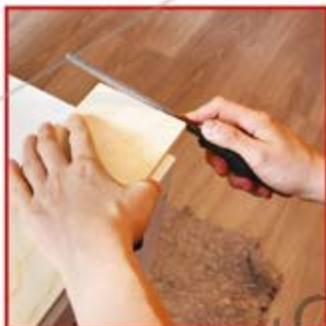
**4** Das Brett kannst du anschließend an der Schnittfläche glatt feilen, damit keine Späne abstehen. Außerdem kannst du mit der Feile kleine Unebenheiten ausgleichen.
