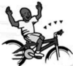
Normale Räder sind bei den Rennen, an denen Ludwig teilnimmt, nicht zu gebrauchen. Aber Mountainbikes sind speziell für das Fahren im Gelände gebaut. Sie haben breite Reifen mit starkem Profil, einen stabilen Rahmen und meistens eine Federung an der Gabel, die das Vorderrad hält. Die Lenkstange des Mountainbikes ist auch nicht geschwungen.
